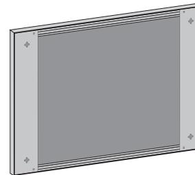
Die Montage erfolgt mit zwei (oder wahlweise vier) Schrauben, an denen der Wegweiser durch die Sternstanzung aufgehängt wird.
