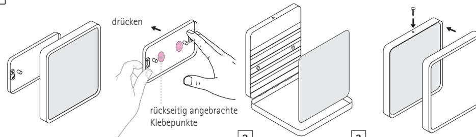
**1** Nach dem Bohren der Löcher die Dübel in das Bohrloch stecken und die Montageplatte mit Schrauben locker befestigen. Montageplatte ausrichten und die Schrauben festziehen.
